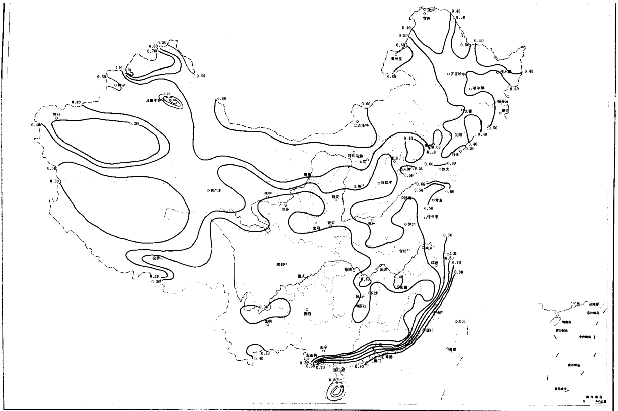
附图 D.5.3 全国基本风压分布图(单位: \text{kN/m}^2 )
